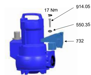
Fig. 10: Montaje del soporte con 1 barra guía
