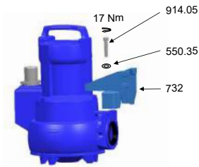
Abb. 10: Halterung montieren bei 1-Stangenführung
