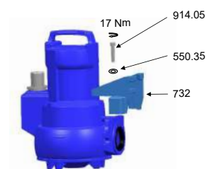
Fig. 10: Montar o suporte na versão com 1 barra
