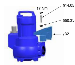
Fig. 10: Montaggio supporto con guida per 1 barra
